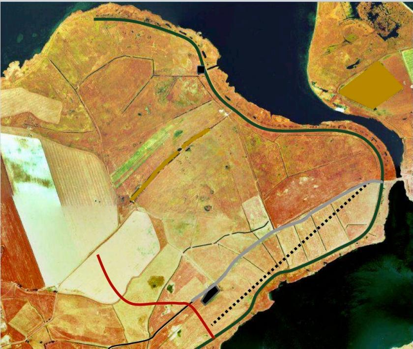
Abb 5: Maßnahmen des Renaturierungsprojektes 1993/1994. Rot: Neubau Riegeldeich. Grün: Rückbau Deich. Grau: Erhöhung Fahrdamm. Photo: aus C. Herrmann 2016
